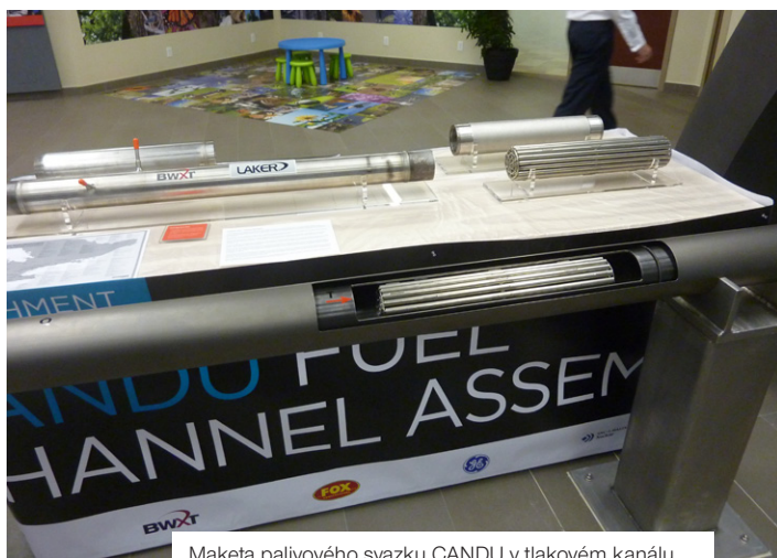
Maketa palivového svazku CANDU v tlakovém kanálu
